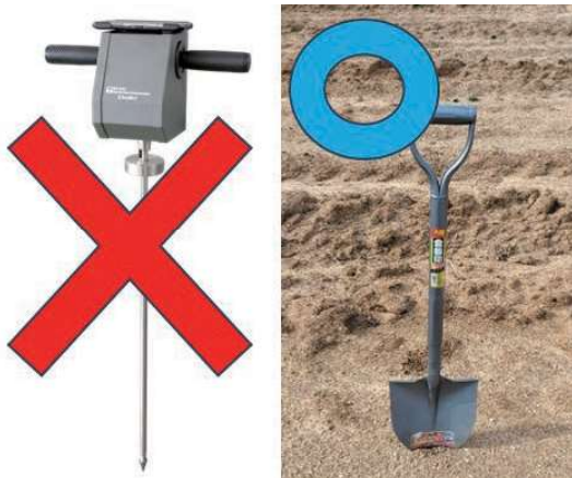
写真1 貫入式土壌硬度計と剣先スコップ (今回は剣先スコップを用いて調査実施)
